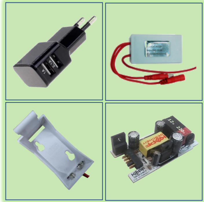
Электропитание от батареек, от адаптера 5V или блока внешнего питания
